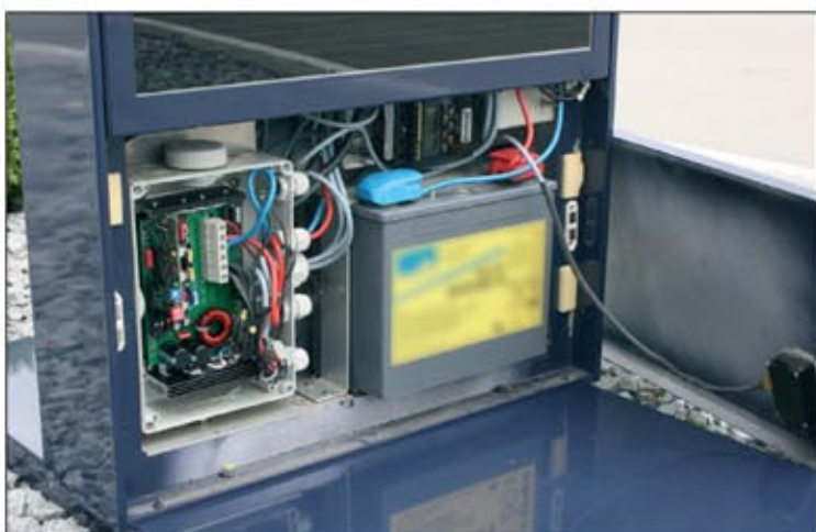
Im Gehäuse befinden sich unter anderem der Akku (u. r.), die Zeitschaltuhr (o. r.) und sonstige Technik wie der Tiefentladeschutz, der sicherstellt, dass der Akku nie völlig leer wird.
